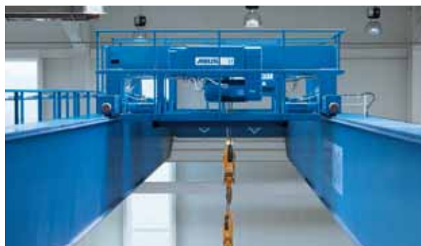
Särskilt servicevänlig med serviceplattform: ABUS lintelfer modell DB
