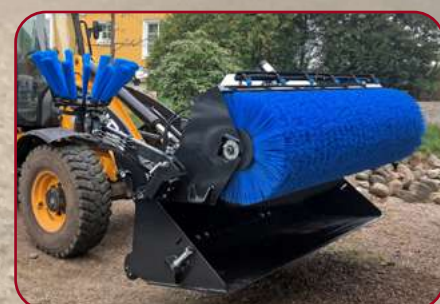
Sopskopen töms genom att lyfta upp borstrotorn och sen tippa skopen
