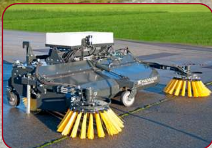
Sopvals SV-230HB Proffs med monterade sidoborstar och vattensystem
