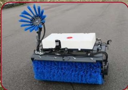
Sopskopa SS-155 med monterad sidoborste och vattensystem
