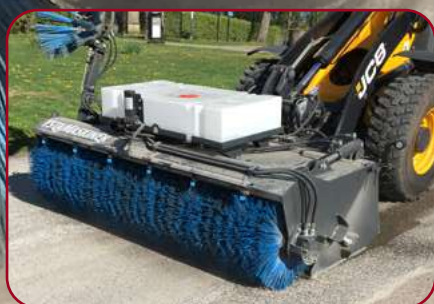
Sopskopa SS-250 med monterad sidoborste och vattensystem
