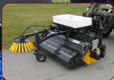
Sopvals SV-210HB med monterat vattensystem och sidoborste
