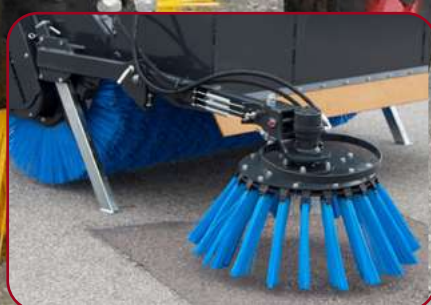
Sidorborsten går att använda även med uppfälld box
