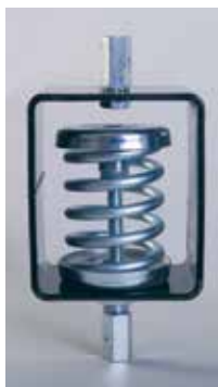
När mycket låga resonansfrekvenser önskas väljs stålfjäderhängare
