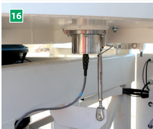
16 Fugtsensor til blademær (ekstraudstyr) Fugtsensor monteret i blademærket til måling af fugtigheden i betonblandingen.
