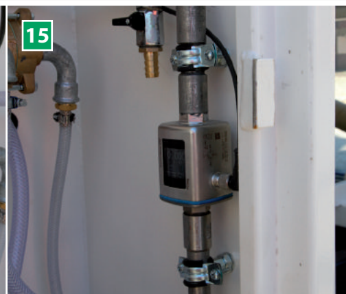
15 Flowmeter for additiver (ekstraudstyr) Elektromagnetisk flowmeter, 1/2" i rustfrit stål, max. 16 bar, temperatur -10 til + 70 °C, mindste ledningsevne 20 µS / cm. Flowmåleren sikrer en doseringsnøjagtighed på +/- 1 % (gentagne gange +/- 0,2 %).
