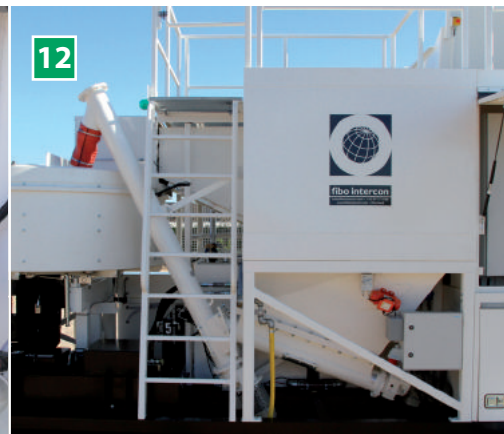
12 Big bag Silo 2.0 m 3 (ekstraudstyr) Siloen er med indikatorer for fyldt og tom. Komplet med snegl, kontravægt, kegle med udgangsflange, topluge, gitter til cementindløb, kniv til bigbags, gaffeltruckslisker, løftekrøge og vibrator.
