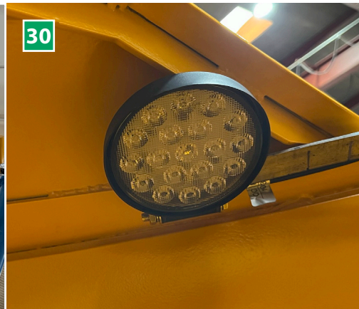
30 Lys i blander (ekstraudstyr) Giver bedre udsyn i blandekarret, når man kigger gennem inspektionslugen, eller for at give ekstra lys i kombination med et kamera monteret i blandekarret.
