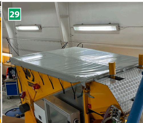
29 Overdækning af silokasser (ekstraudstyr) Aftagelig PVC pressening til beskyttelse af silokasserne og deres indhold mod regn o. lign. Let og hurtig påsætning med manuelt spil.
