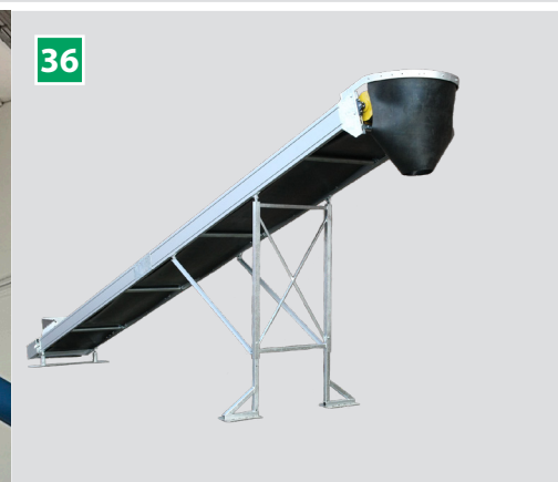
36 Båndtransportør (ekstraudstyr) Båndtransportør med en båndbredde på 0,8 m eller 1,0 m og en længde på 8-14 m. Kan leveres med højdejusterbare ben eller hydraulisk system til automatisk drift. Alle transportører er komplet udstyret med en tromlemotor, integrerede gearkasser, indløb, udløbstragt samt løftkrog for nem transport.
