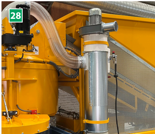
28 Støvfiler til blandekarret (ekstraudstyr) Filter til at reducere cementstøv i omgivelserne under doseringen.
