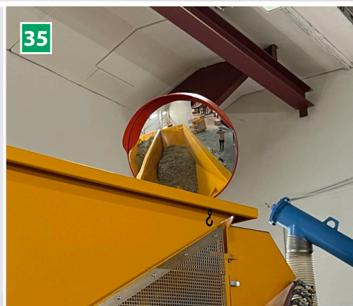
35 Spejl (ekstraudstyr) Spejlet giver let udsyn til, hvor meget der er i silokasserne.
