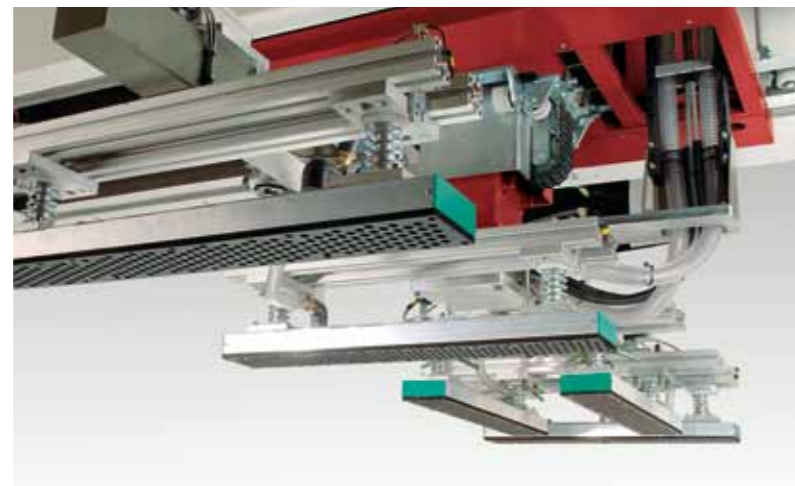
Telaio a cassoni aspiranti Suction air pads
