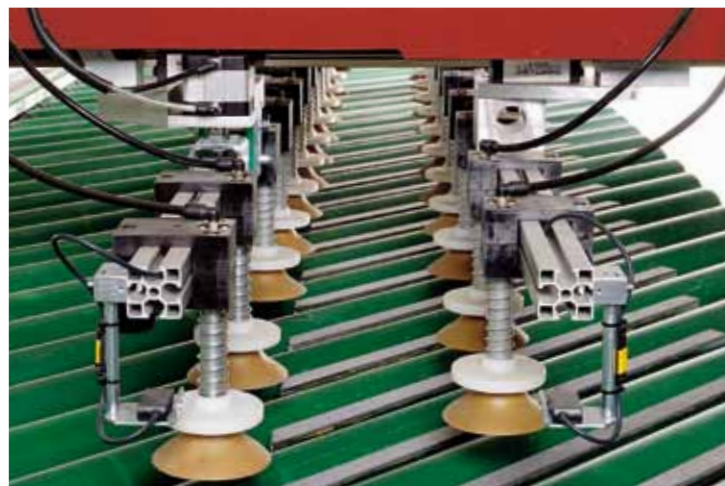
Telaio portaventose con dispositivo pneumatico di distacco pannelli Vacuum cups frame with pneumatic separation device
