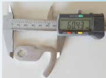
Small piece 60mm processed on table with vacuum system Kleines Teil 60mm auf vakumtisch verarbeitet
