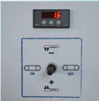
Digital display for thickness Digitale Materialstärkenanzeige
