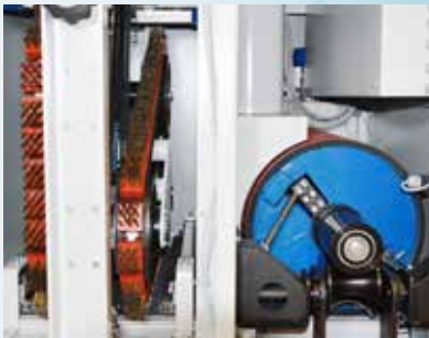
D group big drum with belt + C group brushes blocks unit D gruppe große Trommel und Schleifband + C gruppe Bürstenblöcke
