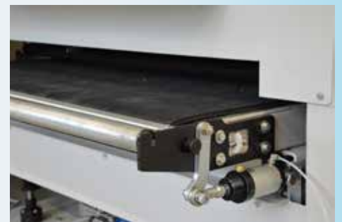
Pneumatic system for centering conveyor belt Pneumatik für die Zentrierung des Transportbandes
