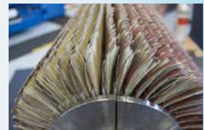
Brush unit for light deburring Bürsten für leichtes Entgraten
