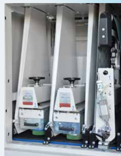
RTT Groups - 1 belt unit + 2 top brushes units RTT Gruppe - 1 Schleifbandeinheit + 2 Tellerbürsteneinheiten
