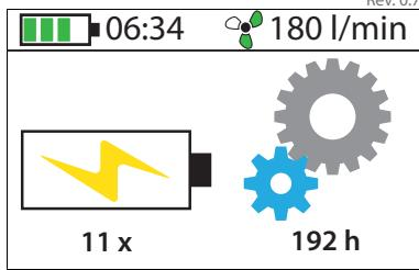
Batteriet tæller automatisk hver fuld opladning i ladestationen. De respektive ladecyklusser for det tilsluttede batteri vises i menuen med driftsinformationer.
