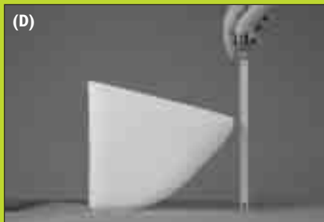
(D) With the elevator bucket back held vertical, measure height to front lip (D). Con la espalda del cangilón vertical, medir la altura hasta el labio frontal (D).
