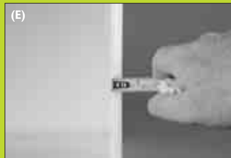
(E) Using a micrometer, measure the thickness of the steel bucket. Use a micrometer or ruler for plastic buckets. Usando un micrómetro, medir el espesor del cangilón de chapa. Usar una micrómetro o una regla para los cangilones plásticos.
