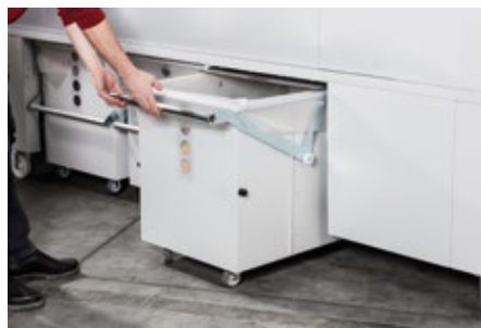
Spänebehälter wieder einsetzen und Staubschott entfernen
