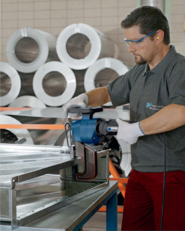
Ob in der Lüftungs- und Klimatechnik, beim Behälter- oder Apparatebau: Fügen ist die wohl einfachste und wirtschaftlichste Art, zwei Metallteile zu verbinden. Die TRUMPF Fügepresse drückt beiden Metallteilen eine formschlüssige Falte ins Blech – und fertig ist eine erstaunlich feste, haltbare Verbindung. Kein Schrauben oder Nieten, kein Vor- oder Nachbearbeiten, keine Emissionen.
