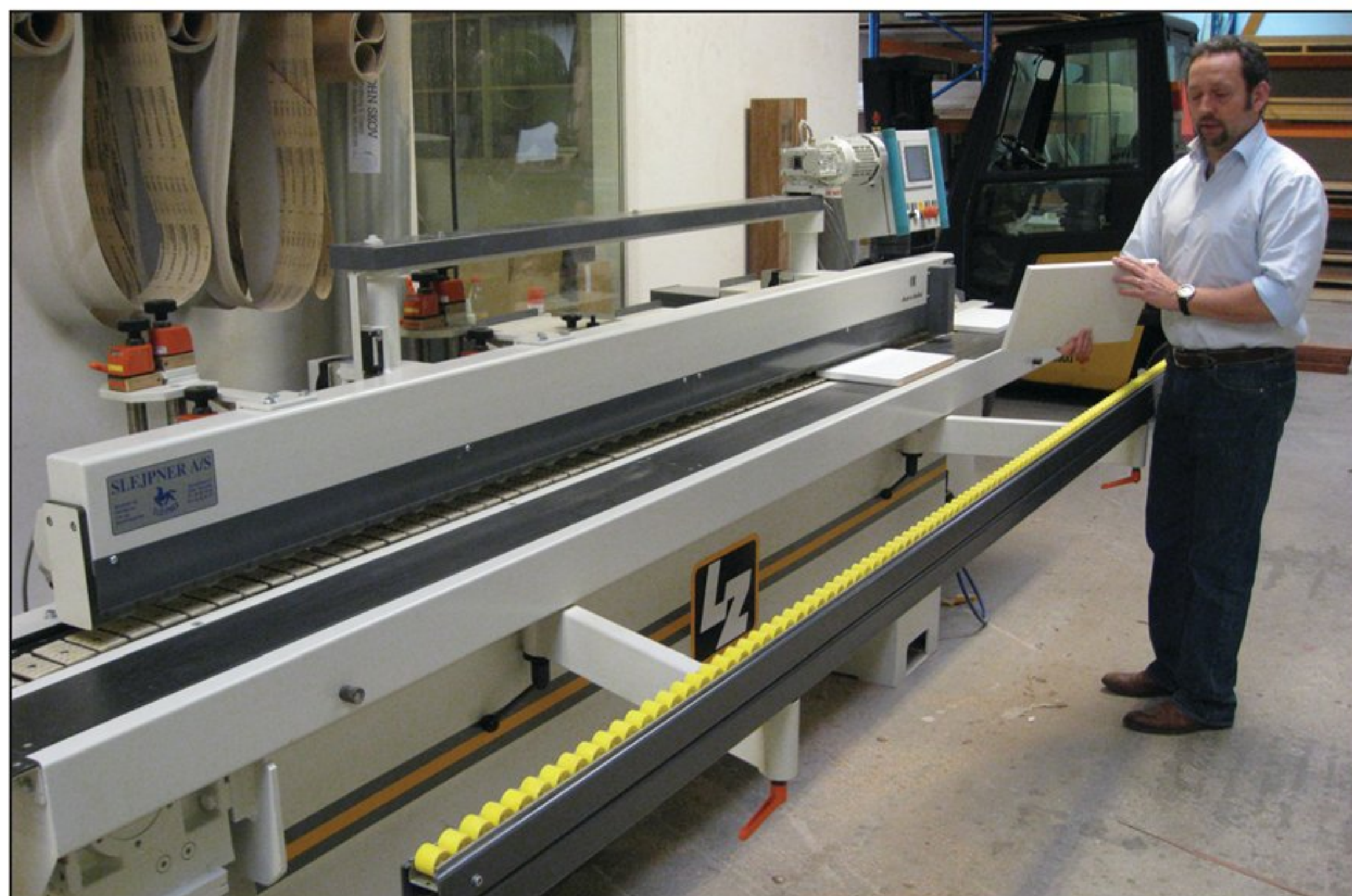
- Før grundlak kantslibes den rå plade med korn 120, 150 og 240 i de tre stationer, hvorefter diamantfræserne sørger for affasning eller afrunding, fortæller Erik Heilmann, fra Slejpnær A/S.
