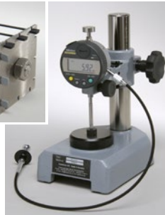
Tjockleksmätare EV 01 är avsedd för mätning av gummi och plast enligt ISO 23529 och sättningsprovning av gummi enligt ISO 815.
