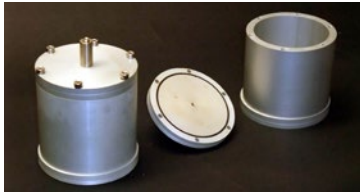
Tjockleksmätare EV 01 är avsedd för mätning av gummi och plast enligt ISO 23529 och sättningsprovning av gummi enligt ISO 815.
