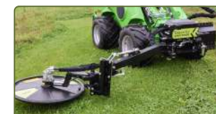
Kant-/Stolpklippare RI monterad.
