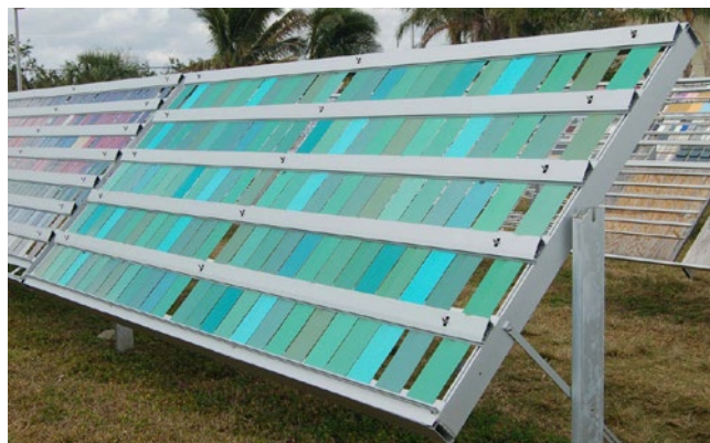
Q-Labs anläggning för utomhusprovning i subtropiskt klimat i Florida.
