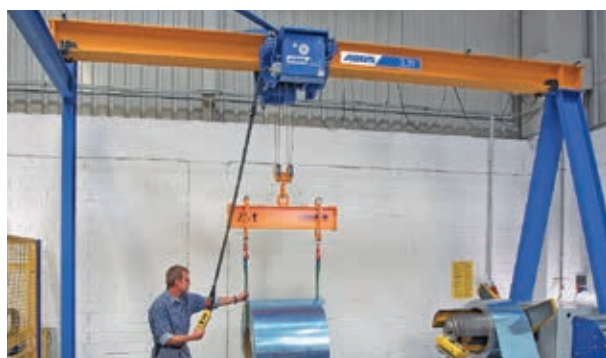
Telfer på telferbana.
