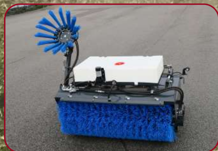
Sopskopa SS-155 med monterad sidoborste och vattensystem
