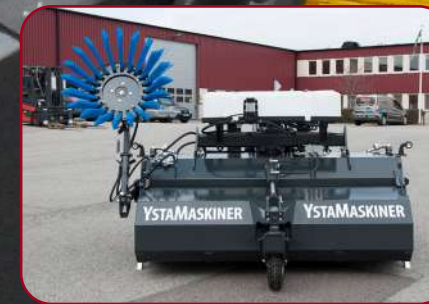
Sopvals SV-280HB Proffs med monterad sidoborste och vattensystem
