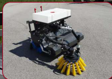
Sopvals SV-130HB med monterad sidoborste och vattensystem
