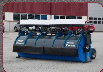
Sopvals SV-300 med 300 liter vattensystem
