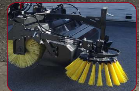
Sidoborste med mekanisk uppfällning och tre olika inställningsmöjligheter
