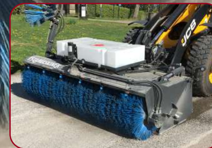
Sopskopa SS-250 med monterad sidoborste och vattensystem
