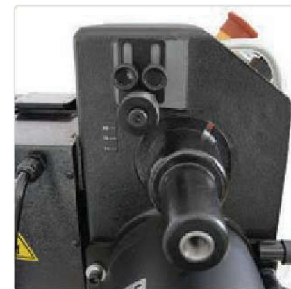
Indeksring af spindel
