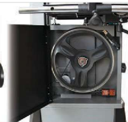
Nedre hjul udstyret med en støvbørste
