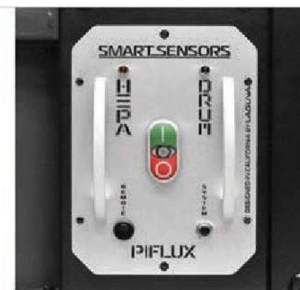
Fjernbetjening + kontrolpanel med LED-indikatorer
