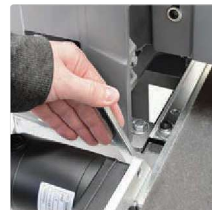
Indekséringsstang justerer transportbåndet for et fejlfrit finish
