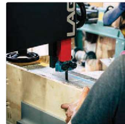
Højde på snit 305 mm
