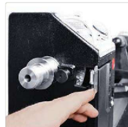
Indeksring af spindel i 24 Punkter
