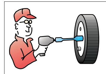
Momentlylsorna är konstruerade för åtdragning av bilhjul med slående mutterdragare. Den långa och smala midjan dämpar överskottskraften i mutterdragaren.
