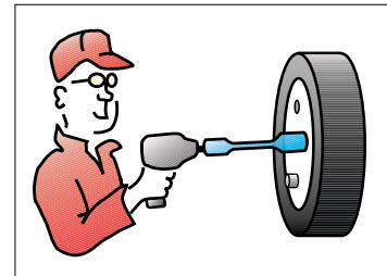
Momentylsorna är konstruerade för åtdragning av bilhjul med slående mutterdragare. Den långa och smala midjan dämpar överskottskraften i mutterdragaren.
