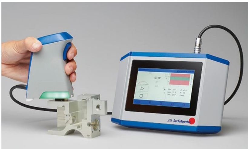
Mobil mätanordning för kontaktvinkel för att kontrollera rengöring av delar och ytaktivering.
