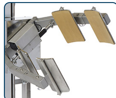
Drivet klämverktyg för vridning av fat/rullar
