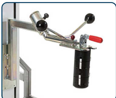
Rullexpander för att lyfta och rotera rullen 90°
